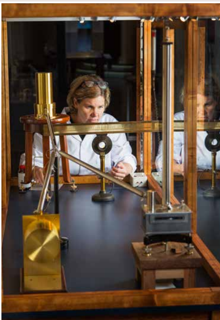
Åsa Husberg är en av de museilärare som, med en exakt kopia av originalutrustningen, kan utföra det experiment med vars hjälp Pierre och Marie Curie kunde mäta radioaktivitet.
